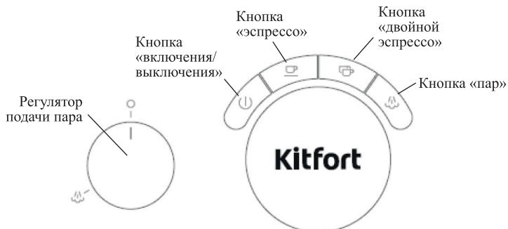
**Кнопка «включения/выключения»** позволяет включить или выключить нагрев кофеварки после подключения к сети. Также кнопкой «включения/выключения»
